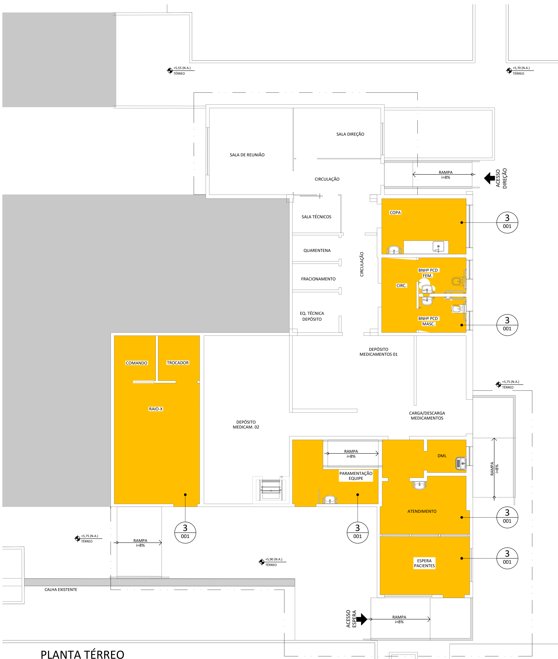
6 PLANTA TÉRREO IMPERMEABILIZAÇÃO DOS PISOS ESCALA 1/50
